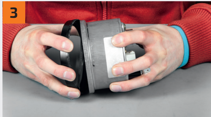
Lösen Sie die Gehäuseabdeckung vom Gehäuse – Vorsicht mit den scharfen Kanten! Remove the housing cover from the housing – Pay attention to the sharp edgings!
