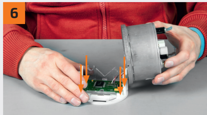
Entfernen Sie vorsichtig das Gehäuse. Beachten Sie, dass noch Kabel am Gehäuse sind. Entfernen Sie die Schrauben, um die Platine vom Display zu trennen. Remove the housing carefully. Note that there are still cables at the housing. Remove the screws in order to separate the circuit board from the display.
