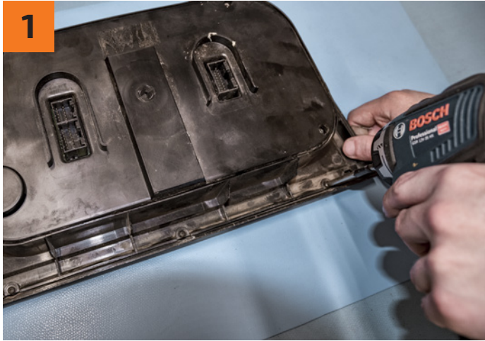
Entfernen Sie ALLE Schrauben auf der Rückseite des Instrumentenbrettes.
