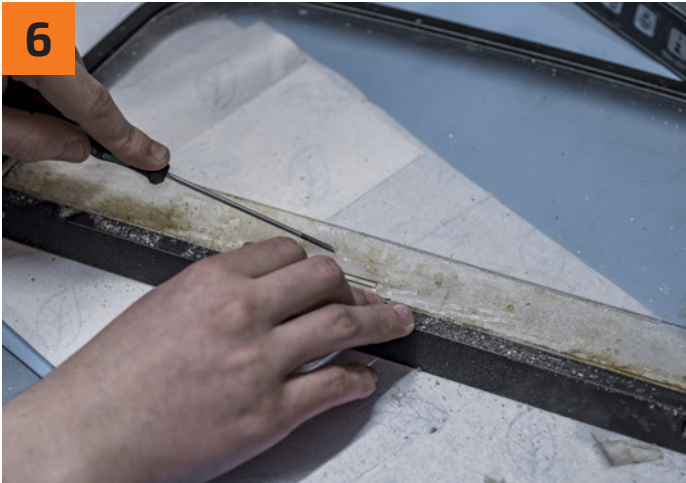
Entfernen Sie die übrigen Klebereste.
