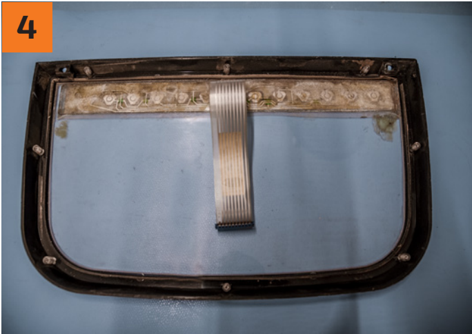
Ziehen Sie das Flachbandkabel durch die Aussparung und entfernen Sie dann die Frontabdeckung des Instrumentenbrettes.
