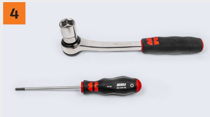
4 Für das Wechseln der Tastatur benötigen Sie einen Torx-Schraubendreher TX20 und eine Ratsche mit 19er Nuss. To exchange the keyboard, you need a Torx screwdriver TX20 and a ratchet with 19mm nut.
