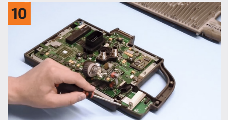
10 Entfernen Sie nun das Halteeisen. Now remove the holding iron.
