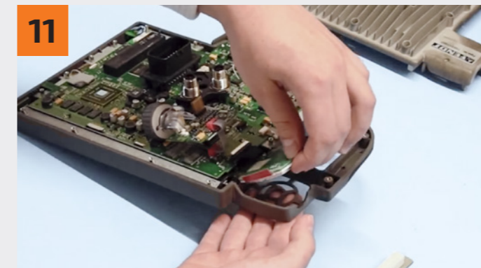
11 Jetzt können Sie die defekte Tastatur entfernen. Now you can remove the defective keyboard.
