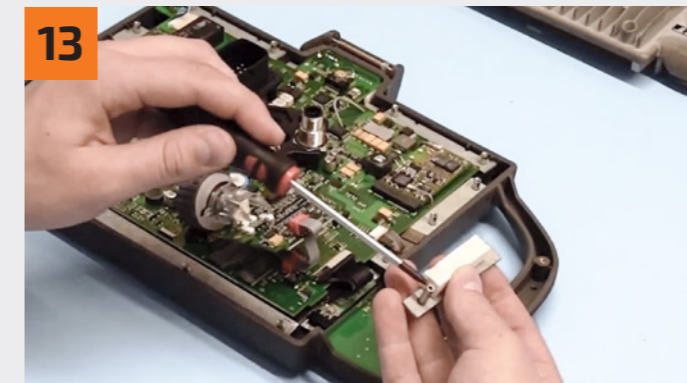
13 Das Halteeisen wieder einsetzen und dabei auf die korrekte Ausrichtung achten. Reinsert the holding iron while observing the correct alignment.
