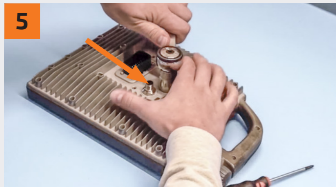
5 Lösen Sie zunächst die 2 Muttern mit der Ratsche. First loosen the 2 nuts with the ratchet.
