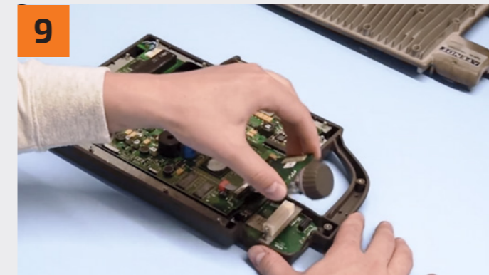
9 Die Platine mit dem Drehencoder anheben und Richtung Hauptplatine klappen. Lift the circuit board with the rotary encoder and fold it over towards the main circuit board.
