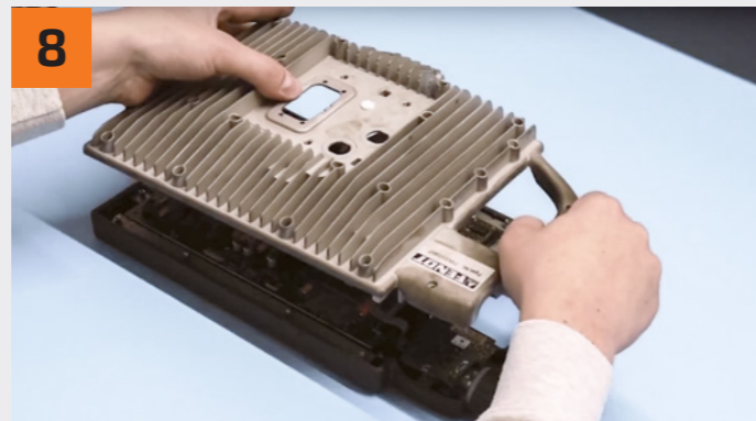
8 Jetzt können Sie den Deckel nach oben ziehen und abnehmen. Now you can pull the cover up and remove it.
