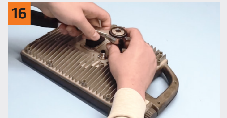
16 ...sicher verschließen. Die Torx-Schrauben und Muttern dabei nur handfest anziehen. ...lock it securely in place. Tighten the Torx bolts and nuts only hand-tight.
