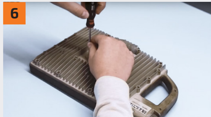
6 Entfernen Sie dann alle Schrauben (insgesamt 30 Stück). Then remove all of the bolts (a total of 30 bolts).
