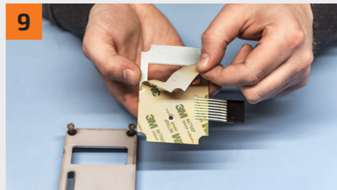
Entfernen Sie die Schutzfolie von der Klebefläche. Remove the protective film from the adhesive surface.
