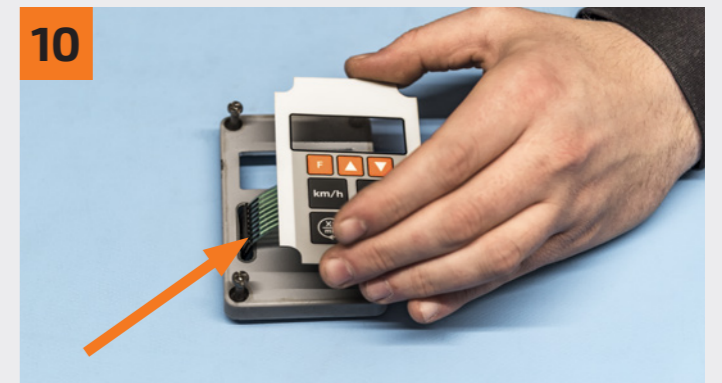
Führen Sie den Stecker durch den dafür vorgesehenen Schlitz. Insert the plug through the slot provided.
