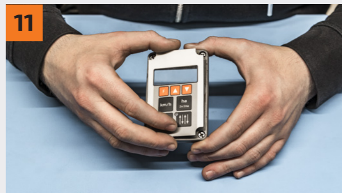
Platzieren Sie die Tastatur so genau wie möglich und drücken Sie diese an den Deckel. Place the keyboard as close as possible and press it against the lid.
